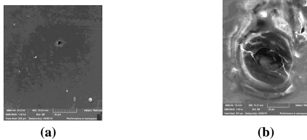
Gambar 4. Hasil SEM (a) Membran Kitosan (b) Membran Kitosan-Silika Perbesaran 1000x
